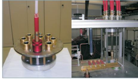
BL...N Buchsen für eine steckbare Hochstromverbindung
